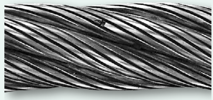
Beispiel kurze Bruchlücke im verdichteten Seil [Quelle: IFT Uni Stuttgart]
