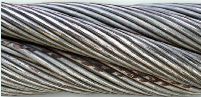
Druckspuren an einem Kreuzknoten nach längerem Betrieb
