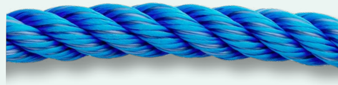
18 mm Schlepliftförderseil aus Kunstfasern im Trossenschlag
