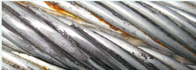
Sanierte Stelle nach dem Ausschleifen [Quelle: IFT Uni Stuttgart]
