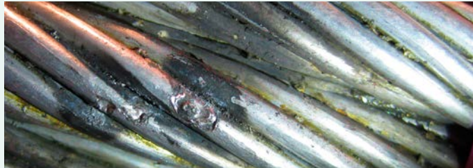
Durch Blitzschlag beschädigte Drähte [Quelle: IFT Uni Stuttgart]
