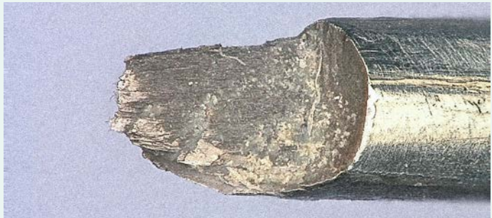
Detail eines Ermüdungsbruchs mit ebener Bruchfläche im Seilbahnseil
