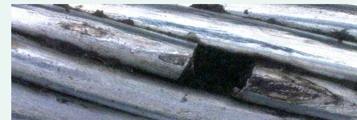
Litzen und Drähte haben an den Berührstellen vor dem Bruch des Drahtes aneinander gerieben
