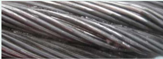
Gleiche Stelle nach Herausbrechen des Drahtes [Quelle: IFT Uni Stuttgart]
